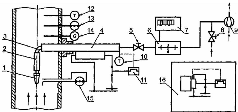
1 — пробоотборный зонд; 2 — сепаратор; 3 — колено; 4 — пробоотборная магистраль с контролируемой температурой; 5 — запорный клапан; 6 — дроссель расходомера;
