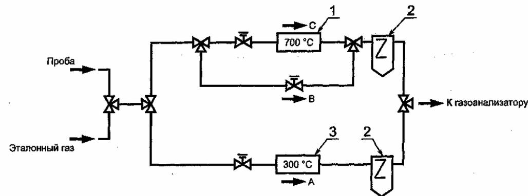
1 — конвертер; 2 — влагоотделитель с холодильником; 3 — конвертер из графита
