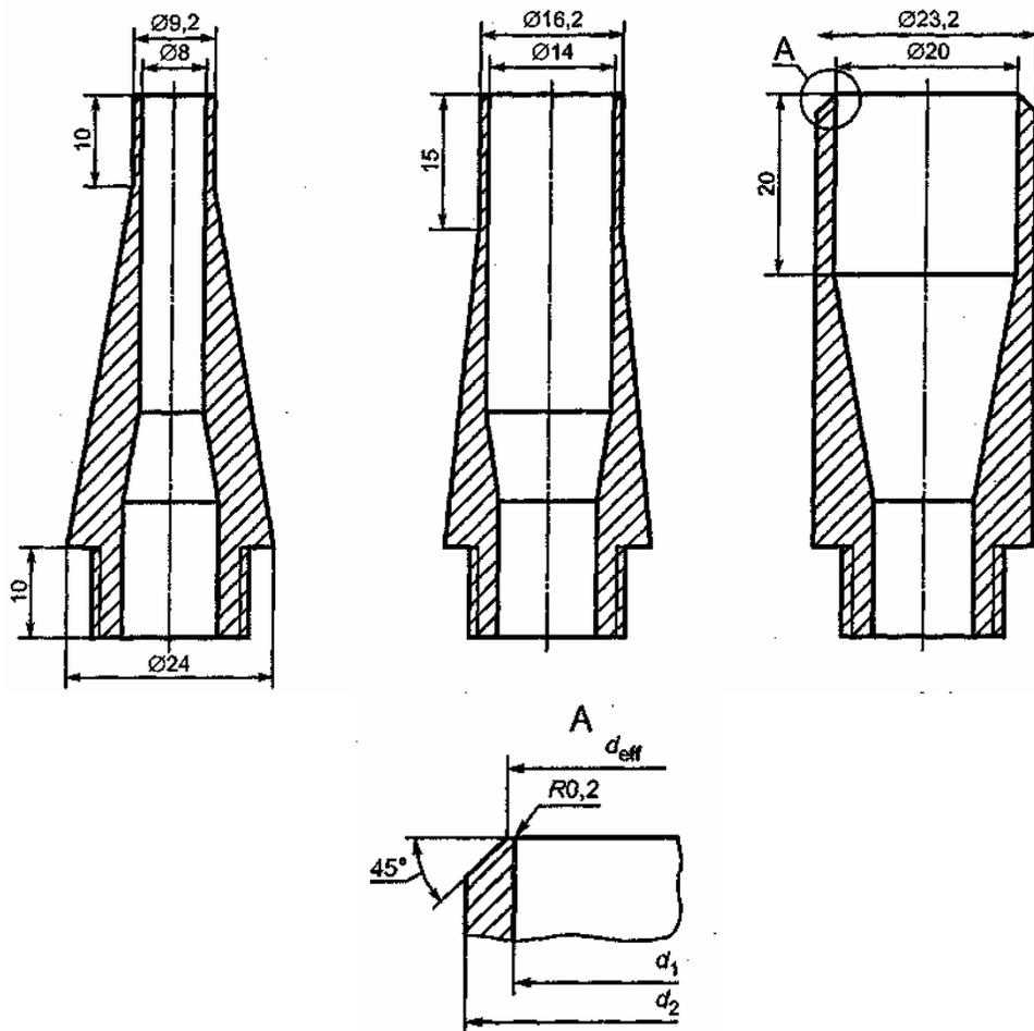
$d_1$  — внутренний диаметр приемного отверстия зонда;  $d_2$  — внешний диаметр приемного отверстия зонда;  $d_{eff}$  — эффективный диаметр приемного отверстия зонда
