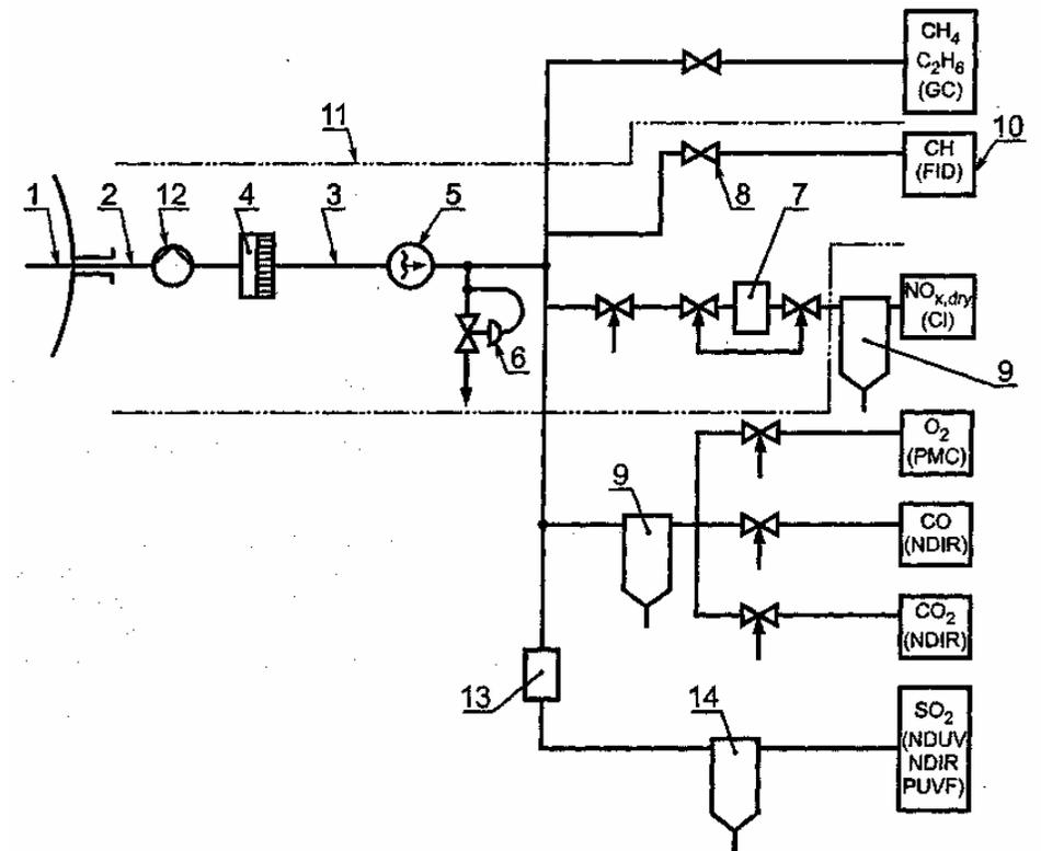
1 — пробоотборный зонд; 2 — подвод газа для проверки системы; 3 — магистраль для транспортировки пробы; 4 — фильтр; 5 — насос для прокачки пробы; 6 — регулятор противодавления; 7 — конвертер NO<sub>2</sub> → NO; 8 — подвод газа для градуировки средств измерения; 9 — осушитель пробы (холодильник, функционирует
