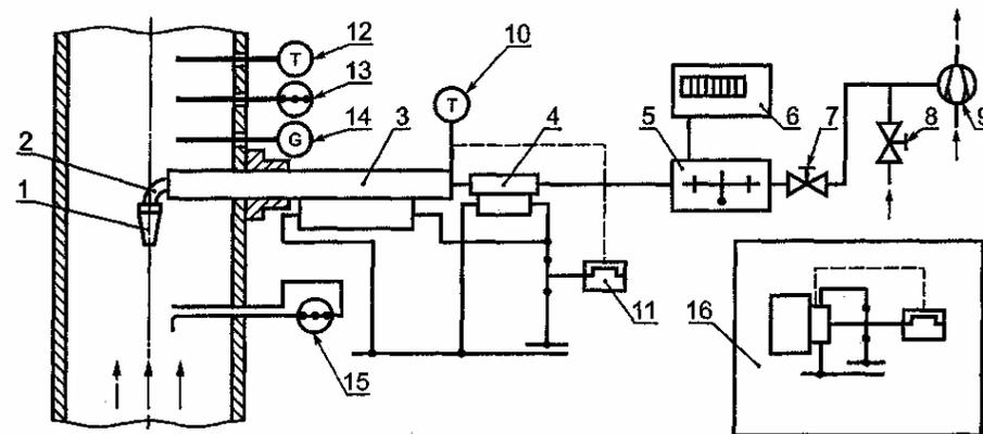
1 — пробоотборный зонд; 2 — колено; 3 — пробоотборная магистраль с контролируемой температурой; 4 — сепаратор; 5 — дроссель расходомера; 6 — индикатор расхода;
