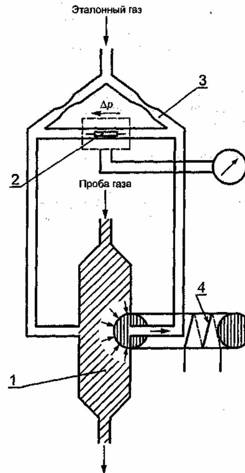
1 — камера измерений; 2 — микродатчик расхода; 3 — капилляры; 4 — электромагнит
