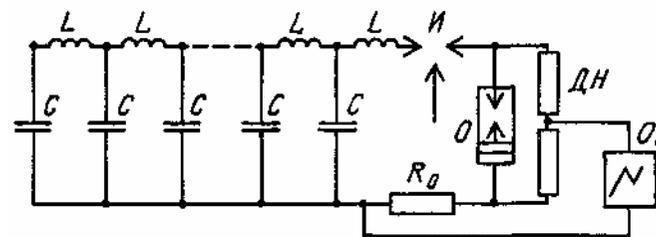
$C, L$  — емкости и индуктивности генератора импульсов тока большой длительности соответственно;  $И$  — управляемый искровой промежуток;  $R_0$  — шунт для измерения тока;
