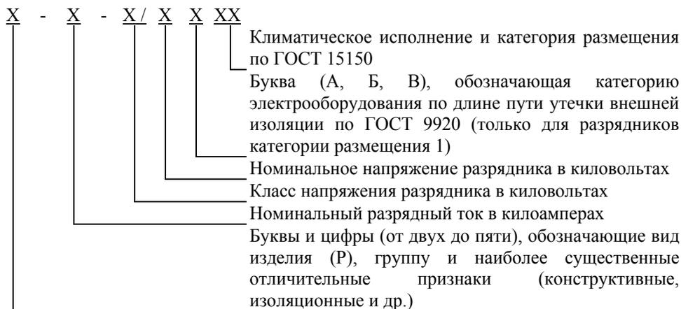
Пример условного обозначения разрядника вентильного серийного группы III на
